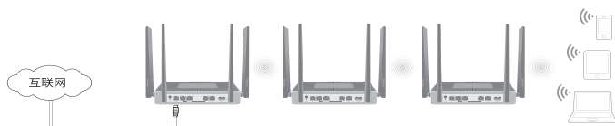
图5-1 开启设备集中管理功能的组网拓扑（一）
